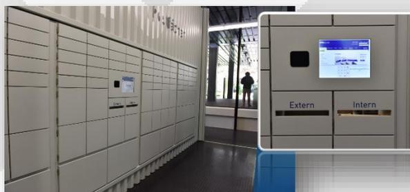
Exemple de système avec un terminal de commande à écran tactile et un lecteur RFID ou NFC
